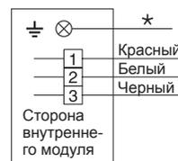
\*Заземлите пульт дистанционного управления, если он имеет провод заземления.
