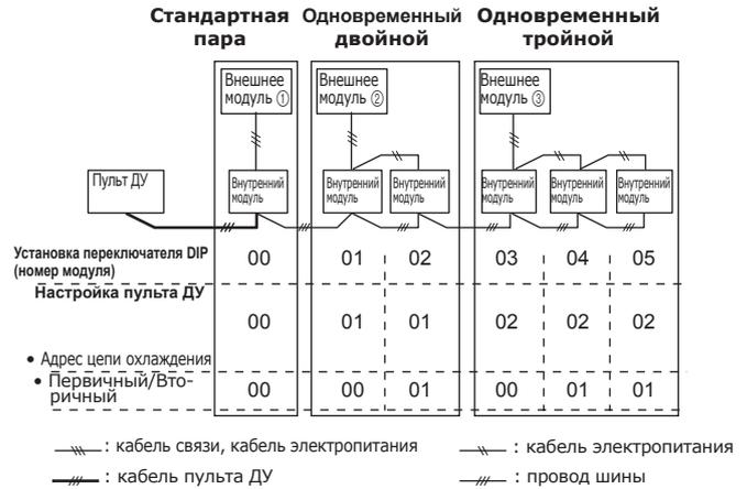
\* Убедитесь, что внутренний модуль с номером 0 подключен к внешнему модулю с помощью кабеля связи.
